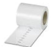
Marker für Klemmen, Rolle, weiß, unbeschriftet, beschriftbar mit: THERMOMARK ROLL, THERMOMARK ROLL X1, THERMOMARK ROLLMASTER 300/600, THERMOMARK X1.2, THERMOMARK S1.1, perforiert, Montageart: verrasten in Universalschildchennut, verrasten in flacher Schildchennut, für Klemmenbreite: 6,2 mm, Schriftfeldgröße: 6,35 x 6,15 mm
