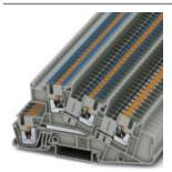
Installationsetagenklemme, Push-in-Anschluss, Querschnitt: 0,14 mm² - 4 mm², AWG: 26 - 12, Breite: 5,2 mm, Farbe: grau, Montageart: NS 35/7,5, NS 35/15
