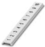
Zackband flach, Streifen, weiß, beschriftet, längs bedruckt: fortlaufende Zahlen 1-10, 11-20 usw. bis 491-500, Montageart: verrasten in flacher Schildchennut, für Klemmenbreite: 5 mm, Schriftfeldgröße: 5,15 x 5,15 mm
