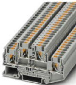
Doppelstockklemme, Anschlussart: Push-in-Anschluss, Querschnitt: 0,2 mm<sup>2</sup> - 6 mm<sup>2</sup>, AWG: 24 - 10, Breite: 6,2 mm, Farbe: grau, Montageart: NS 35/7,5, NS 35/15
