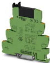
PLC-INTERFACE, bestehend aus Grundklemme PLC-BPT.../21 mit Push-in-Anschluss und steckbarem Miniatur-Solid-State-Relais, zur Montage auf Tragschiene NS 35/7,5, 1 Schließer, Eingang: 48 V DC, Ausgang: 24-253 V AC/ 0,75 A
