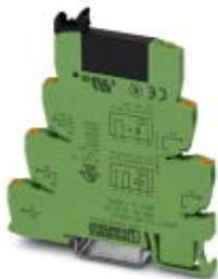
PLC-INTERFACE, bestehend aus Grundklemme PLC-BPT.../21 mit Push-in-Anschluss und steckbarem Miniatur-Solid-State-Relais, zur Montage auf Tragschiene NS 35/7,5, 1 Schließer, Eingang: 60 V DC, Ausgang: 3-48 V DC/100 mA
