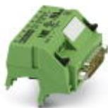
V8-Adapter für 8 x PLC-INTERFACE (6,2 mm); Steuerung: SPS-Systemverkabelung von Eingangskarten; Anschluss 1: Steckanschluss; Anschluss 2: 1x D-SUB-Stiftleiste (15-polig); Anzahl der Kanäle: 8; Ansteuerlogik: plusschaltend
