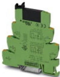
PLC-INTERFACE, bestehend aus Grundklemme PLC-BPT.../21 mit Push-in-Anschluss und steckbarem Miniatur-Solid-State-Relais, zur Montage auf Tragschiene NS 35/7,5, 1 Schließer, Eingang: 48 V DC, Ausgang: 3-48 V DC/100 mA
