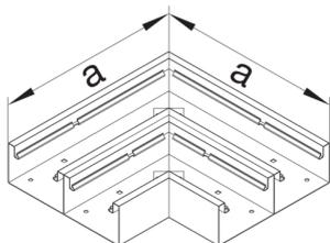
**Flachwinkel aus Grundprofil zu BRS 100x210mm OT 2x80mm aus Stahlblech verzinkt**
