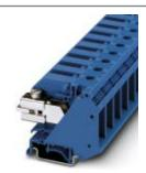
N-Trennklemme, zur Neutralleiter-Trennung, Spezial- und Mischanschluss, Querschnitt: 0,75 mm² - 35 mm², AWG: 18 - 2, Breite: 15 mm, Farbe: blau, Montageart: NS 35/7,5, NS 35/15
