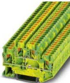
Schutzleiter-Doppelstockklemme, Anschlussart: Push-in-Anschluss, Querschnitt: 0,14 mm<sup>2</sup> - 4 mm<sup>2</sup>, AWG: 26 - 12, Breite: 5,2 mm, Farbe: grün-gelb, Montageart: NS 35/7,5, NS 35/15
