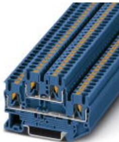
Doppelstockklemme, Anschlussart: Push-in-Anschluss, Querschnitt: 0,14 mm<sup>2</sup> - 4 mm<sup>2</sup>, AWG: 26 - 12, Breite: 5,2 mm, Farbe: blau, Montageart: NS 35/7,5, NS 35/15
