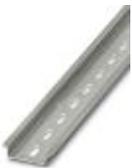
Tragschiene gelocht, Standardprofil, Breite: 35 mm, Höhe: 7,5 mm, nach EN 60715: 2001, Material: Stahl, verzinkt, dickschichtpassiviert, Länge: 2000 mm, Farbe: silber
