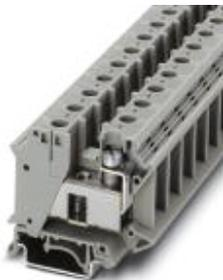
Installationsklemme, Schraubanschluss, Querschnitt: 0,75 mm<sup>2</sup> - 35 mm<sup>2</sup>, AWG: 18 - 2, Breite: 15,2 mm, Farbe: grau, Montageart: NS 35/7,5, NS 35/15
