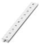
Marker für Klemmen, Streifen, weiß, beschriftet, beschriftbar mit: CMS-P1-PLOTTER, längs: L1, L2, L3, N, PE, L1, L2, L3, N, PE, Montageart: verrasten in hoher Schildchennut, für Klemmenbreite: 10,2 mm, Schriftfeldgröße: 10,15 x 10,5 mm
