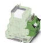
V8-Adapter für 8 x PLC-INTERFACE (6,2 mm); Steuerung: SPS-Systemverkabelung von Ausgangskarten; Anschluss 1: Steckanschluss; Anschluss 2: 1x IDC/FLK-Stiftleiste (14-polig); Anzahl der Kanäle: 8; Ansteuerlogik: plusschaltend
