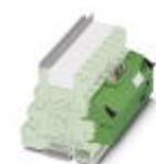
V8-Adapter für 8 x PLC-INTERFACE (14 mm); Steuerung: SPS-Systemverkabelung von Ausgangskarten; Anschluss 1: Steckanschluss; Anschluss 2: 1x IDC/FLK-Stiftleiste (14-polig); Anzahl der Kanäle: 8; Ansteuerlogik: plusschaltend
