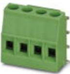
Leiterplattenklemme, Nennstrom: 24 A, Nennspannung: 400 V, Rastermaß: 5 mm, Polzahl: 4, Anschlussart: Schraubanschluss mit Zughülse, Montage: Wellenlöten, Anschlussrichtung Leiter/Platine: 0 °, Farbe: grün. Artikel mit seitlichem Pinabgang
