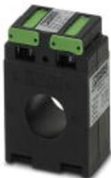
Rohrstabstromwandler, Primärstrom 125 A AC; Sekundärstrom 5 A AC; Genauigkeitsklasse 1; Bemessungsleistung 3,75 VA
