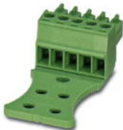
Steckerteil, Nennstrom: 8 A, Bemessungsspannung (III/2): 160 V, Polzahl: 5, Rastermaß: 3,5 mm, Anschlussart: Schraubanschluss mit Zughülse, Farbe: grün, Kontaktoberfläche: Zinn
