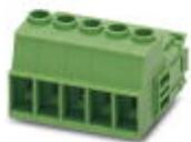
Steckerteil, Nennstrom: 41 A, Bemessungsspannung (III/2): 1000 V, Polzahl: 10, Rastermaß: 7,62 mm, Anschlussart: Schraubanschluss mit Zughülse, Farbe: grün, Kontaktoberfläche: Zinn
