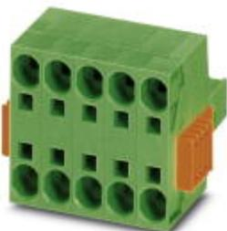
Steckerteil, Nennstrom: 41 A, Bemessungsspannung (III/2): 1000 V, Polzahl: 10, Rastermaß: 7,62 mm, Anschlussart: Push-in-Federanschluss, Farbe: grün, Kontaktoberfläche: Zinn
