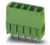
Grundgehäuse, Nennstrom: 41 A, Bemessungsspannung (III/2): 630 V, Polzahl: 10, Rastermaß: 7,62 mm, Farbe: grün, Kontaktfläche: Zinn, Montage: Wellenlöten
