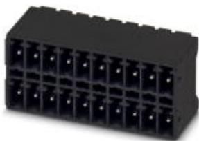
Grundgehäuse, Nennstrom: 8 A, Bemessungsspannung (III/2): 160 V, Polzahl: 10, Rastermaß: 3,81 mm, Farbe: schwarz, Kontaktoberfläche: Zinn, Montage: THR-Löten, Die Pinlänge beträgt 1,4 mm. Anwenderinformationen und Designempfehlungen zur Through Hole Reflow Technologie finden Sie unter "Downloads".
