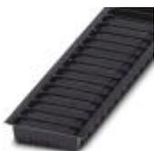
Grundgehäuse, Nennstrom: 8 A, Bemessungsspannung (III/2): 160 V, Polzahl: 2, Rastermaß: 3,81 mm, Farbe: schwarz, Kontaktoberfläche: Zinn, Montage: THR-Löten, Anwenderinformationen und Designempfehlungen zur Through Hole Reflow Technologie finden Sie unter 'Downloads'
