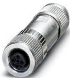
Bussystem-Steckverbinder, PROFINET CAT5 (100 MBit/s), 4-polig, geschirmt, Buchse gerade M12, D-kodiert, Schneidklemmanschluss, Rändelmaterial: Messing, vernickelt, Kabelaußendurchmesser 4 mm ... 8 mm
