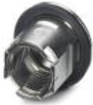
M12-Gewindehülse mit toleranzausgleichender Funktion, für gerade, THR-fähige M12-Buchsenkontakteinsätze. Geeignet für Frontplattenwandstärken von 1,7 mm ... 2,5 mm.
