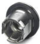
M12-Gewindehülse mit toleranzausgleichender Funktion, für gerade, THR-fähige M12-Buchsenkontakteinsätze. Geeignet für Frontplattenwandstärken von 3,1 mm ... 3,9 mm.
