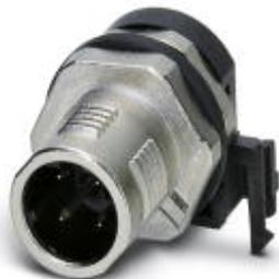
Sensor-/Aktor-Einbausteckverbinder, Stecker, 4-polig, M12-SPEEDCON, A-kodiert, geschirmt, Hinterwand-/Schraubmontage mit M12 Gewinde, verdrehgeschützt, mit gewinkelttem Lötanschluss
