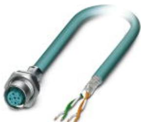
Bus-System-Einbaubuchse, Ethernet, 4-polig, M12, geschirmt, D-kodiert, SPEEDCON, Hinterwand-/Schraubmontage mit Pg9-Gewinde, positionierbar, mit 2,0 m Buskabel, 2 x 2 x 0,2 mm<sup>2</sup>
