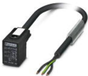
Sensor-/Aktor-Kabel, 3-polig, PUR halogenfrei, schwarzgrau RAL 7021, freies Leitungsende, auf Ventilstecker BI (11 mm), mit 1 LED, beschaltet mit Z-Diode, Kabellänge: 3 m
