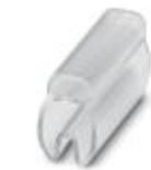
Ader-Bezeichnungsträger, transparent, unbeschriftet, Montageart: aufschieben, Kabeldurchmesserbereich: 4-7 mm, Schriftfeldgröße: 15 x 4 mm
