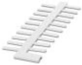
Einsteckschild, Streifen, weiß, unbeschriftet, beschriftbar mit: CMS-P1-PLOTTER, Montageart: auffädeln, Kabeldurchmesserbereich: 0,6-50 mm, Schriftfeldgröße: 15 x 4 mm
