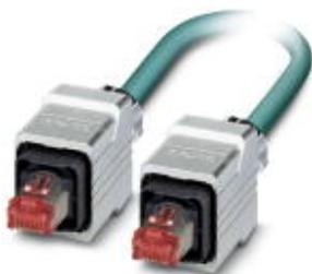
Konfektioniertes Ethernet-Kabel, CAT6, geschirmt, 4-paarig, AWG 26\* flexibel (7-drähtig), RAL 5021 (wasserblau), RJ45-Stecker/IP67 Push-Pull Metallgehäuse auf RJ45-Stecker/IP67 Push-Pull Metallgehäuse, Line, Länge 5 m
