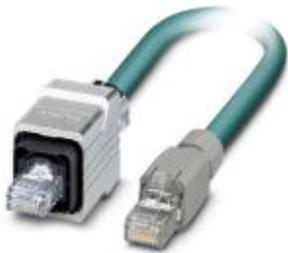
Konfektioniertes Ethernet-Kabel, geschirmt, 4-paarig, AWG 26 schleppkettentauglich (19-drähtig), RAL 5021 (wasserblau), RJ45-Stecker/IP67 Push-Pull Metallgehäuse auf RJ45-Stecker/IP20, Line, Länge 2 m
