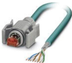
Konfektioniertes Ethernet-Kabel, geschirmt, 4-paarig, AWG 26 flexibel (7-drähtig), RAL 5021 (wasserblau), RJ45-Stecker/IP67, grau auf freies Leitungsende, Line, Länge 5 m
