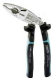
Kombizange, abgewinkelte Form, mit Öffnungsfeder und Arretierung, gegeneinander verzahnte Greiffläche, integriertem Ringschlüssel M8 - M10, VDE 1000 V AC/ 1500 V DC geprüft
