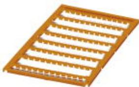
Marker für Klemmen, Matte, orange, unbeschriftet, beschriftbar mit: BLUEMARK CLED, BLUEMARK LED, CMS-P1-PLOTTER, PLOTMARK, Montageart: verrasten in flacher Schildchennut, für Klemmenbreite: 5 mm, Schriftfeldgröße: 4,45 x 5,2 mm
