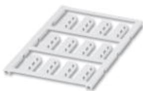
Kabelmarker, Matte, weiß, unbeschriftet, beschriftbar mit: BLUEMARK CLED, BLUEMARK LED, CMS-P1-PLOTTER, PLOTMARK, Montageart: Kabelbindermontage, Kabeldurchmesser: >4 mm, Schriftfeldgröße: 24 x 5 mm
