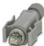
RJ45-Steckverbinder, Schutzart: IP67, Polzahl: 8, CAT5 (IEC 11801:2002), Material: PA, Anschlussart: IDC-Schnellanschluss, Anschlussquerschnitt: AWG 26-23, Kabelabgang: gerade, Farbe: verkehrsgrau A RAL 7042
