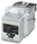
RJ45-Buchseinsatz, Bauform: RJ45, Schutzart: IP20, Polzahl: 8, 10 GBit/s, CAT6<sub>A</sub>, Material: Zink-Druckguss, Anschlussart: IDC-Anschluss, Anschlussquerschnitt: AWG 26-22, Verwendung nur mit IP20-Anbaurahmen oder direkte Integration in die Gehäusewand
