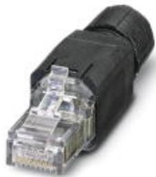
RJ45-Steckverbinder, Schutzart: IP20, Polzahl: 8, 1 GBit/s, CAT5 (IEC 11801:2002), Material: PA, Anschlussart: IDC-Schnellanschluss, Anschlussquerschnitt: AWG 26-23, Kabelabgang: gerade, Farbe: schwarz
