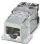
RJ45-Buchseneinsatz, Bauform: RJ45, Schutzart: IP20, Polzahl: 8, 10 GBit/s, CAT6<sub>A</sub>, Material: Zink-Druckguss, Anschlussart: IDC-Anschluss, Anschlussquerschnitt: AWG 26-22
