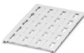
Leitermarker, Matte, weiß, unbeschriftet, beschriftbar mit: BLUEMARK CLED, BLUEMARK LED, CMS-P1-PLOTTER, PLOTMARK, Montageart: aufclipsen, Kabeldurchmesserbereich: 2,8-4,4 mm, Schriftfeldgröße: 15 x 5,5 mm
