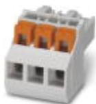
Steckerteil, Nennstrom: 16 A, Bemessungsspannung (III/2): 300 V, Polzahl: 3, Rastermaß: 5 mm, Anschlussart: Push-in-Federanschluss, Farbe: lichtgrau, Kontaktfläche: Zinn
