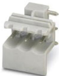
Grundgehäuse, Nennstrom: 12 A, Bemessungsspannung (III/2): 320 V, Polzahl: 3, Rastermaß: 5 mm, Farbe: lichtgrau, Kontaktoberfläche: Zinn, Montage: Lötén
