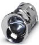
Metall-Verschraubung mit Leitungsbiegeschutz und Zugentlastung, Gewindelänge: 7 mm, Leitungsdichtbereich : 10 - 19 mm, Klemmbereich: 14 - 21 mm, SW 30, Verschraubung: M25
