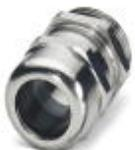
Kabelverschraubung, Material Verschraubung: Messing, vernickelt, Kabelaußendurchmesser 11 mm ... 17 mm, Schirmung: nein, Anschlussgewinde: M25 x 1,5, Farbe: silberfarben, mit O-Ring
