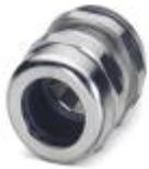
Kabelverschraubung, Material Verschraubung: Messing, vernickelt, Kabelaußendurchmesser 11 mm ... 16 mm, Schirmung: ja, Anschlussgewinde: M25 x 1,5, Farbe: silberfarben, mit O-Ring
