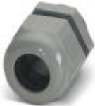
Kabelverschraubung, Material Verschraubung: PA, Kabelaußendurchmesser 11 mm ... 17 mm, Schirmung: nein, Anschlussgewinde: M25 x 1,5, Farbe: silbergrau RAL 7001
