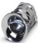
Metall-Verschraubung mit Leitungsbiegeschutz und Zugentlastung, Gewindelänge: 7 mm, Leitungsdichtbereich : 10 - 19 mm, Klemmbereich: 14 - 21 mm, SW 30, Verschraubung: M25
