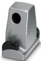
HEAVYCON ADVANCE Standard-Pulverbeschichtet, Tüllengehäuse B6, mit Bajonettverriegelung, Höhe 100 mm, mit Gewinde 1x M25, seitlichem Kabelabgang
