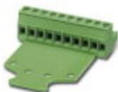
Steckerteil, Nennstrom: 12 A, Bemessungsspannung (III/2): 320 V, Polzahl: 12, Rastermaß: 5,08 mm, Anschlussart: Schraubanschluss mit Zughülse, Farbe: grün, Kontaktoberfläche: Zinn
