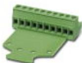
Steckerteil, Nennstrom: 12 A, Bemessungsspannung (III/2): 320 V, Polzahl: 4, Rastermaß: 5,08 mm, Anschlussart: Schraubanschluss mit Zughülse, Farbe: grün, Kontaktoberfläche: Zinn
