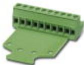
Steckerteil, Nennstrom: 12 A, Bemessungsspannung (III/2): 320 V, Polzahl: 9, Rastermaß: 5,08 mm, Anschlussart: Schraubanschluss mit Zughülse, Farbe: grün, Kontaktoberfläche: Zinn
