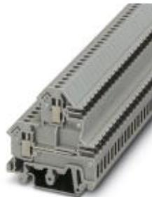
Doppelstockklemme, 32-polig geblockt, Nennstrom: 10 A, Nennspannung: 250 V, Querschnitt: 0,2 mm<sup>2</sup> - 4 mm<sup>2</sup>, AWG: 24 - 12, Montageart: NS 35/7,5, NS 35/15, NS 32, Polzahl: 32, Rastermaß: 5,08 mm, Breite: 88,9, Farbe: grau
