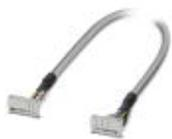
Konfektioniertes, halogenfreies Rundkabel; Anschluss 1: IDC/FLK-Buchsenleiste (1x 14-polig); Anschluss 2: IDC/FLK-Buchsenleiste (1x 14-polig); Kabellänge: 2 m
