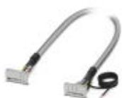
Konfektioniertes, geschirmtes Rundkabel; Anschluss 1: IDC/FLK-Buchsenleiste (1x 14-polig); Anschluss 2: IDC/FLK-Buchsenleiste (1x 14-polig) (Das Schirmgeflecht ist auf ein separates Kabelende herausgeführt.); Kabellänge: 3 m
