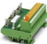
VARIOFACE-Übergabemodul für Siemens SIMATIC® S7-300, für max..16 Kanäle mit SIMATIC®-spezifischer Beschriftung (1 - 20), Messertrennklemme und Prüfabgriff, Modulbreite: 113 mm
