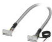
Konfektioniertes, geschirmtes Rundkabel; Anschluss 1: IDC/FLK-Buchsenleiste (1x 14-polig); Anschluss 2: IDC/FLK-Buchsenleiste (1x 14-polig) (Das Schirmgeflecht ist auf ein separates Kabelende herausgeführt.); Kabellänge: 1 m
