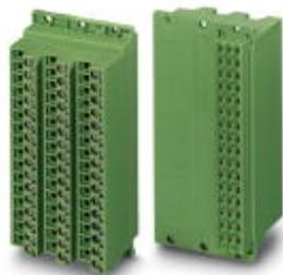
Schraub-Federleiste, Nennstrom: 4 A, Polzahl: 48, Rastermaß: 0 mm, Anschlussart: Schraubanschluss, Farbe: grün, Kontaktoberfläche: Zinn
