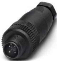
Steckverbinder, 4-polig, Stecker gerade M12, A-kodiert, Schraubanschluss, Rändelmaterial: Kunststoff, Kabelverschraubung Pg7, Kabelaußendurchmesser 4 mm ... 6 mm
