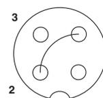
Polbild Buchse M12, 3-polig, PIN 2+4 gebrückt, A-kodiert, Ansicht Buchsen- und Steckerseite
