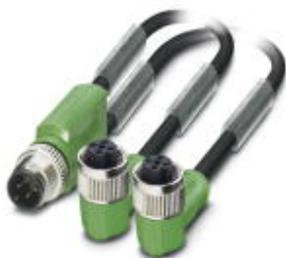
Sensor-/Aktor-Kabel, 3-polig, PUR halogenfrei, schwarzgrau RAL 7021, Stecker gerade M12, A-kodiert, auf Buchse gewinkelt M12, A-kodiert, PIN 2+4 gebrückt und Buchse gewinkelt M12, A-kodiert, PIN 2+4 gebrückt, Kabellänge: 0,6 m
