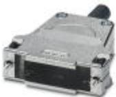
D-SUB-Tüllengehäuse, Schutzart: IP20, Material: Zink-Druckguss, Kabelabgang: gerade, Gehäusegröße: 3, Farbe: metallisch blank
