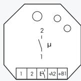
**1 Schließer potenzialfrei 10 A/250 V AC, Glühlampen 2000 Watt, Rückfallverzögerung mit Ausschaltvorwarnung und Taster-Dauerlicht zuschaltbar. Verschlüsselter Funk, bidirektionaler Funk und Repeater-Funktion zuschaltbar. Stand-by-Verlust nur 0,3-0,8 Watt.**
