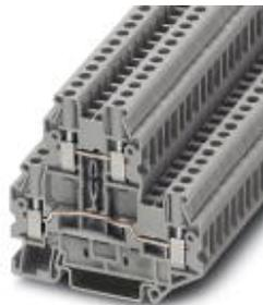
Doppelstockklemme, Anschlussart: Schraubanschluss, Querschnitt: 0,14 mm<sup>2</sup> - 6 mm<sup>2</sup>, AWG: 26 - 10, Breite: 6,2 mm, Farbe: grau, Montageart: NS 35/7,5, NS 35/15
