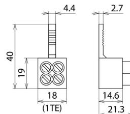
Stiftanschlussklemme zur Umsetzung einer EMV-optimalen Durchgangsverdrahtung nach DIN VDE 0100-534 von Blitzstrom- und Überspannungs-Ableitern.
