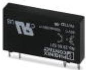
Steckbares Miniatur-Solid-State-Relais, Eingabe-Solid-State-Relais, 1 Schließer, Eingang: 60 V DC, Ausgang: 3-48 V DC/100 mA
