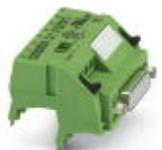
V8-Adapter für 8 x PLC-INTERFACE (6,2 mm); Steuerung: SPS-Systemverkabelung von Eingangskarten; Anschluss 1: Steckanschluss; Anschluss 2: 1x D-SUB-Buchsenleiste (15-polig); Anzahl der Kanäle: 8; Ansteuerlogik: plusschaltend
