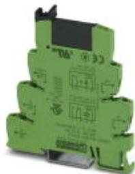
PLC-INTERFACE, bestehend aus Grundklemme PLC-BSC.../21 mit Schraubanschluss und steckbarem Miniatur-Solid-State-Relais, zur Montage auf Tragschiene NS 35/7,5, 1 Schließer, Eingang: 120 V AC/110 V DC, Ausgang: 3-48 V DC/100 mA
