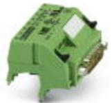
V8-Adapter für 8 x PLC-INTERFACE (6,2 mm); Steuerung: SPS-Systemverkabelung von Eingangskarten; Anschluss 1: Steckanschluss; Anschluss 2: 1x D-SUB-Stiftleiste (15-polig); Anzahl der Kanäle: 8; Ansteuerlogik: plusschaltend
