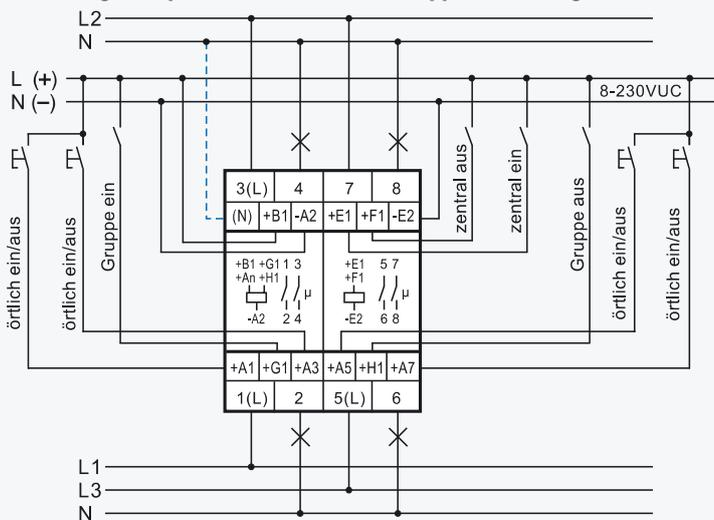
Bei angeschlossenem N ist bei den Kontakten 1-2, 3-4 und 5-6 die Kontaktschaltung im Nulldurchgang aktiv.
