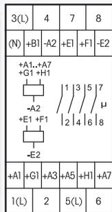
**Mit 4 unabhängigen Kontakten, je 1 Schließer potenzialfrei 16 A/250 V AC, Glühlampen 2000 W. Stand-by-Verlust nur 0,03-0,4 Watt.**
