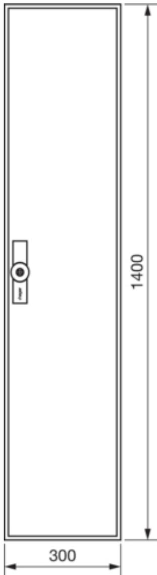
**Zählerschrank, univers Z, 1400x300x205 mm, Schutzklasse II, 108 Platzeinheiten**
