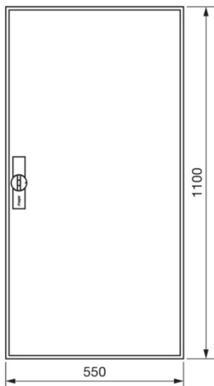
**Zählerschrank, univers Z, 1100x550x160 mm, Schutzklasse II, 168 Platzeinheiten**
